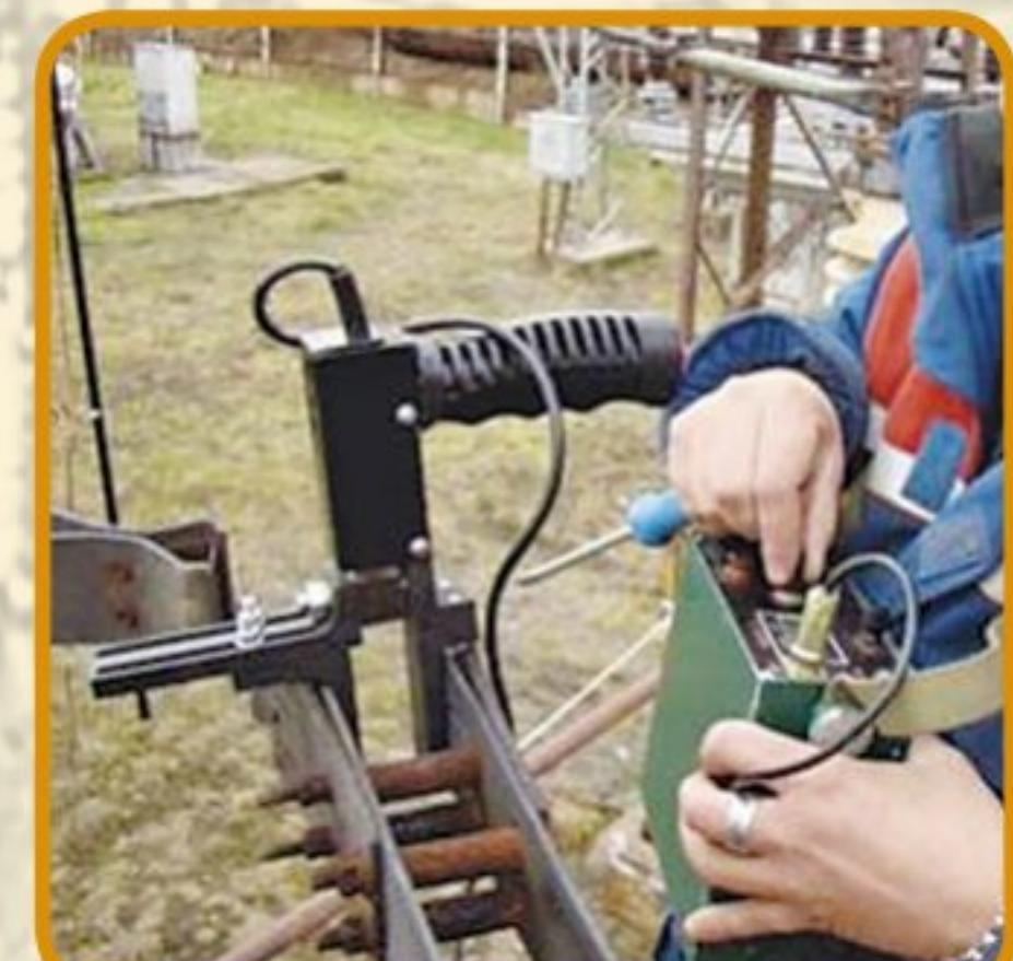
Отсчет усилия нажатия с помощью блока индикации
