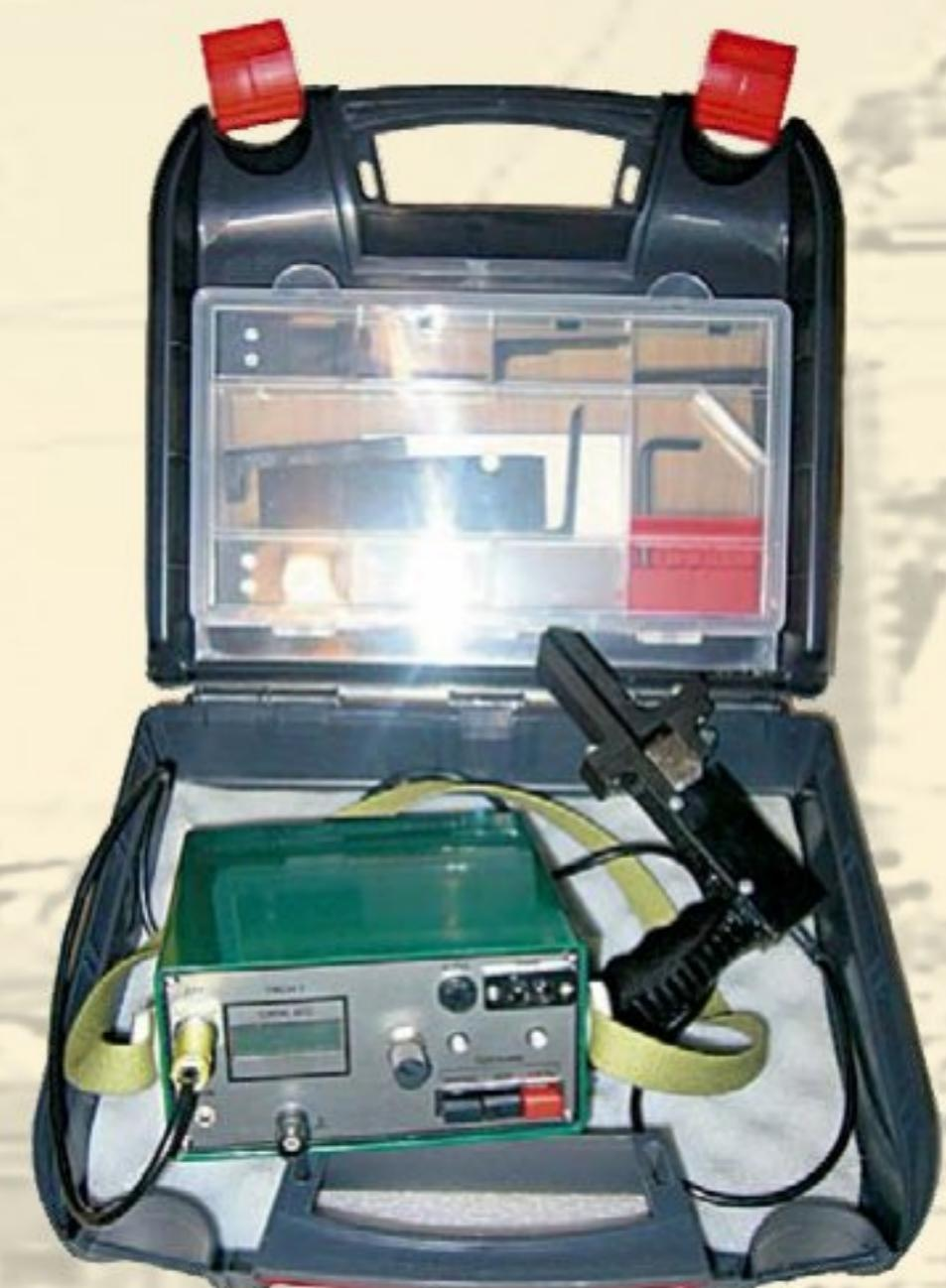
**В комплекте:** блок измерения, контрольный щуп на основе тензорезисторного датчика, соединительный кабель, комплект сменных частей.
