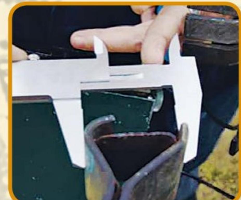
Измерение толщины подвижной ламели контакта с помощью штангенциркуля
